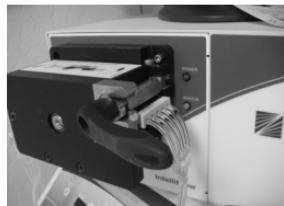
**Schlauchsatz und wiederverwendbarer Okklusionstisch in IntelliFlow Pumpe**
