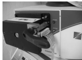
**Slangesæt og Occlusion Bed installeret i IntelliFlow Pumpen**
