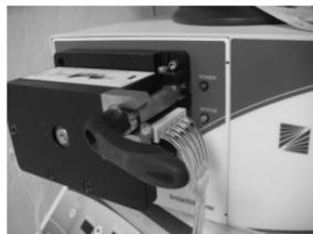
**Conjunto de tubos y plataforma de oclusión reutilizable instalados en la bomba IntelliFlow**
