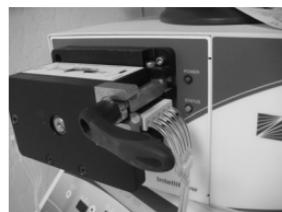
**Tubi e rullo di occlusione riutilizzabile installato nella pompa IntelliFlow**
